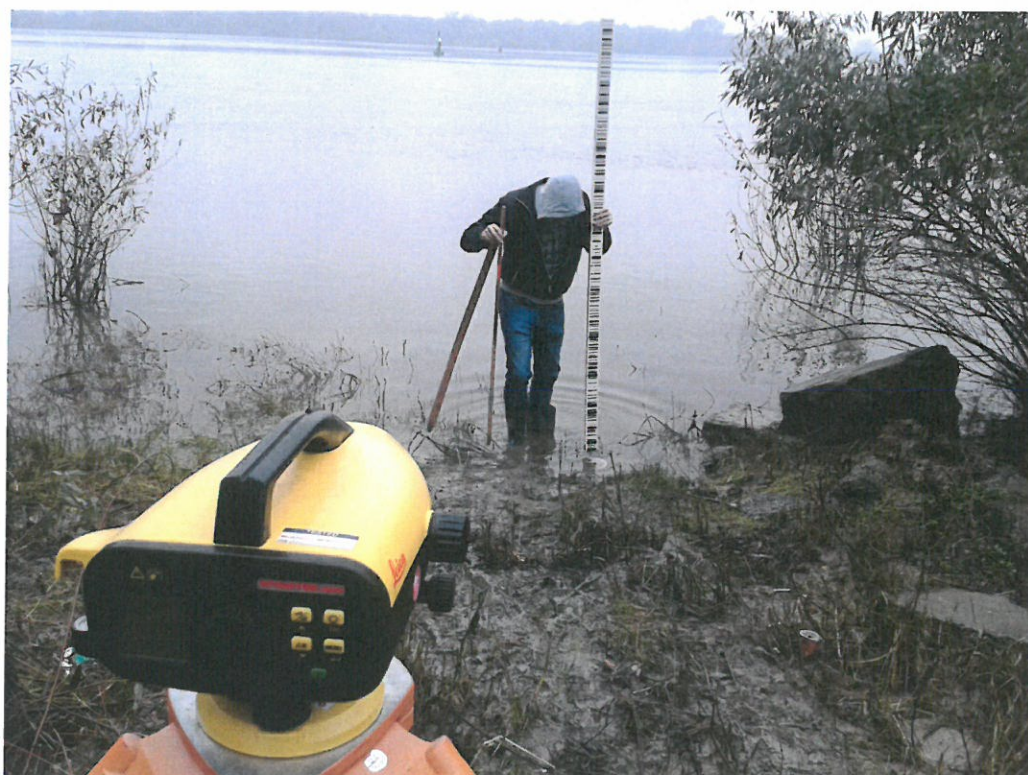
Fig. 18 Imagini din timpul determinărilor cotei nivelului apei (locația L4)
